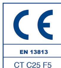
Mortero autonivelante para la preparación de suelos interiores para edificación residencial que una vez endurecido es apto para recibir todo tipo de pavimentos: cerámica, parquet, etc. Espesores de 2 a 10 mm.
